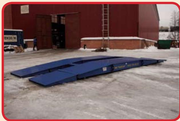
Рис. 5 Сборка весов на месте эксплуатации
