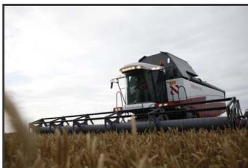
Золотая медаль конкурса инновационной техники АГРОСАЛОН 2010 присуждена **зерноуборочному комбайну TORUM 740 компании Ростсельмаш**. Машина оснащена наклонной камерой и вращающейся декой ротора, что позволяет равномерно подавать массу в молотилку и увеличивать производительность на 20-30%. Комбайн особенно эффективно работает на переувлажненных и засоренных хлебах.
