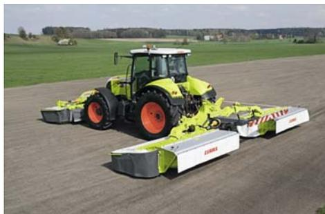
Золотая медаль конкурса инновационной техники АГРОСАЛОН 2010 присуждена **дисковой косилке DISCO 8400 RC Contour компании CLAAS**. Машина оснащена гидро-пневматической системой Active Float для разгрузки косилочного бруса. Применение данной системы снижает загрязнение кормов и расход топлива.
